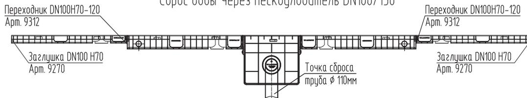
Схема линейного водоотвода при помощи двустороннего каскада лотков "AQUASTOK" DN100.
